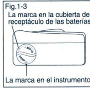
Fig.1-4 Posición de la cubierta del receptáculo de las baterías
